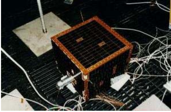
2. ábra. A SEDSAT-1 a vizsgálókamrában az oldalt kinyúló PALADS optikával
