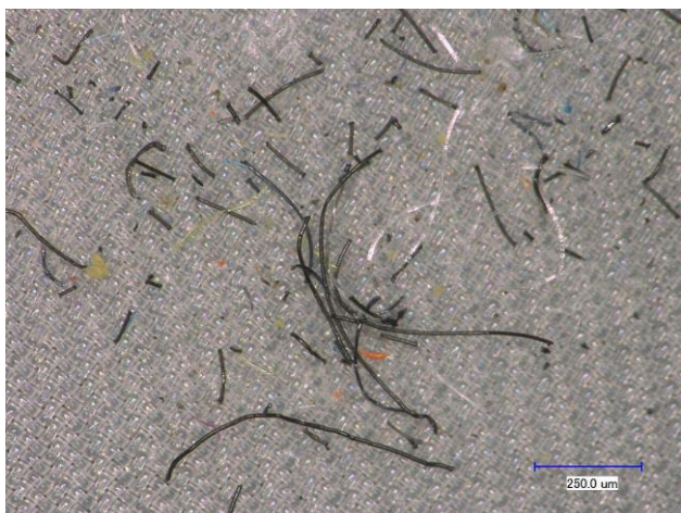
Szálas mikroműanyag-szennyeződés mikroszkóp alatt
