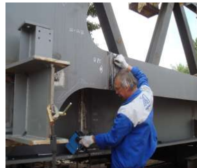
Acélszerkezet helyszíni ultrahangos varratvizsgálata
