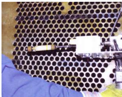
Hőcserélő csövek örvényáramos vizsgálata
