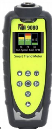
TPI STM 9071 rezgésmérő/spektrum- elemző műszer fordulatszám- méréssel, sávós rezgéselemzésre
