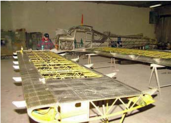
PZL 101 típusú repülőgép nagyjavításába illesztett folyadékpenetrációs vizsgálata.
