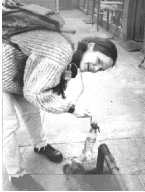
Vízmintavétel zsinegre erősített üvegpalack segítségével. A mintát vevő személy a palackot leereszti a kútba - jelen esetben a fedő kúttető egy részén át.
