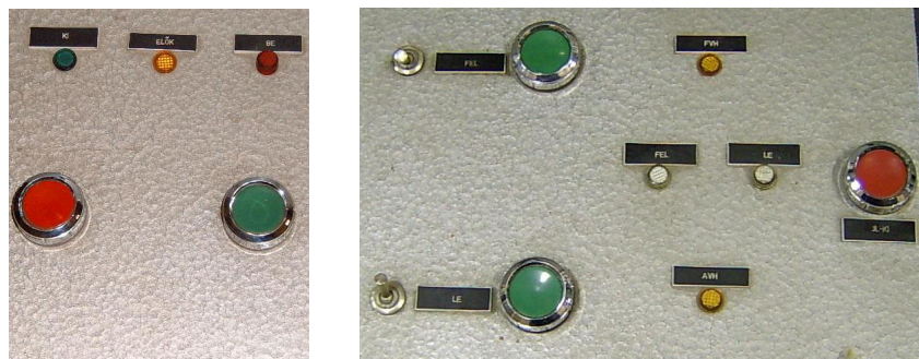
5. ábra: az egyfázisú próbatranszformátor vezérlőpultjának kezelőszervei
