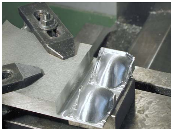
6. ábra A legyártott háromszögmodell (elől) és a felületmodell (hátul) a CNC marógépen
