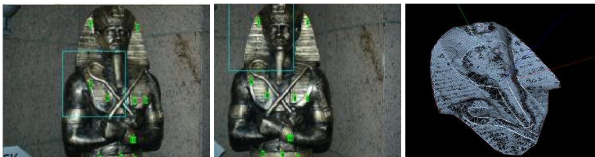
Képpárokból közös pontok segítségével generált térmodell (Topcon ScanMaster szoftver)
