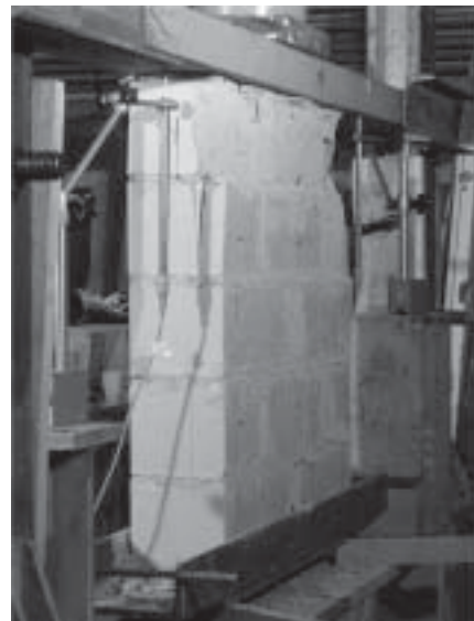
4. ábra. A tönkrement falelem
