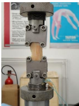
Humán anyag szakítóvizsgálata Instron 8872 szervó hidraulikus fárasztógépen
