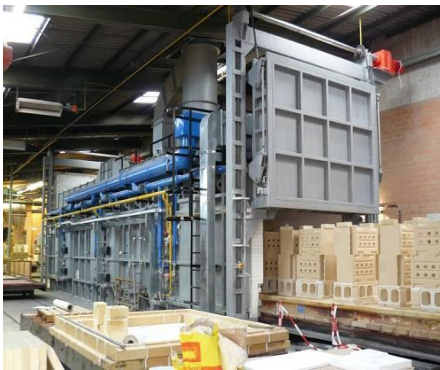
Ipari égetőkemence Refratechnik, Németország. JUMO szabályozók, Siemens PLC, max 1500°C
