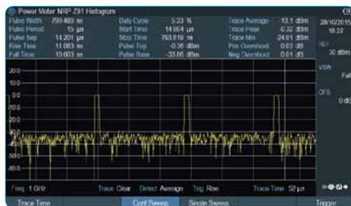
3. ábra Impulzusok elemzése az R&S® FPH-K29-jelű opció és az R&S® NRP-Z8x-sorozatú mérőfejek segítségével
