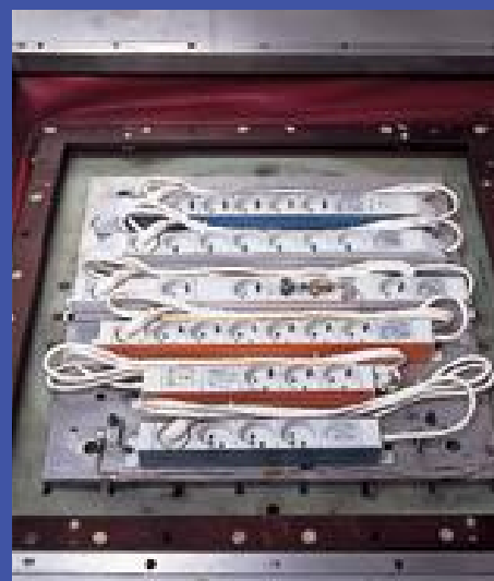
Ütés- és vibrációs vizsgálatok a MIL-STD 810E szabvány szerint különböző hőmérsékleten a fejlesztés lépéseiként
