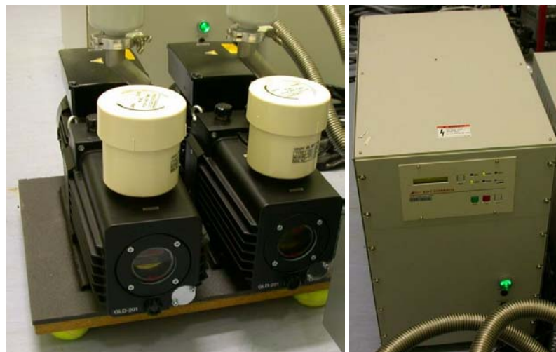
A kiszolgáló teremben található rotációs szivattyúk, és a turbopumpa tápegysége
