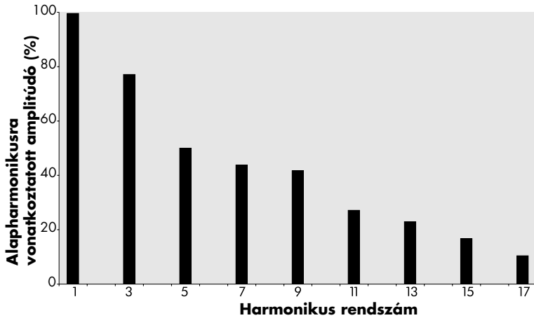
4. ábra. Kompakt fénycső áramának jellegzetes harmonikus spektruma
